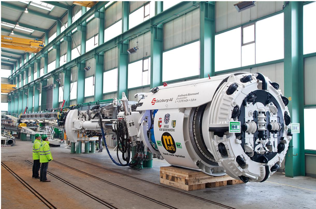
Pic3\_ Die Herrenknecht-Gripper-TBM S-800 ( $\varnothing$  3,8 m) mit extrem starken 1.400-kW-Hochleistungsantrieb für schnelles Vorankommen im Hartgestein.
