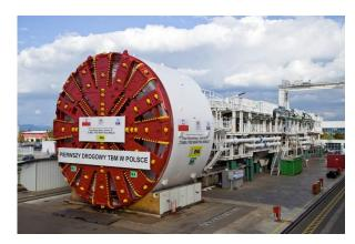
Bild3: Für das Projekt Slowacki-Tunnel designte und lieferte Herrenknecht ein 90 Meter langes Mixschild mit einem Schilddurchmesser von 12,56 Metern.
