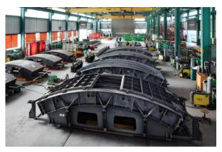
Bild5: Herrenknecht Formwork lieferte für das Projekt millimetergenaue Schalungen für die Produktion von 18 Tonnen schweren Tübbingen.
