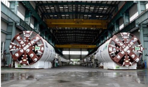
Die nach Stadtteilen benannten Maschinen „Al Thummama“ und „Al Rawada“ mit jeweils 4,47 m Durchmesser und 121 m Länge vor Auslieferung im Herrenknecht Werk. In Katar fahren sie mitten durch Dohas belebten Südwesten unter einer der Hauptstraßen einen 9,7 km langen Tunnel auf. Der Verkehr auf den Straßen fließt dabei ungehindert weiter.
