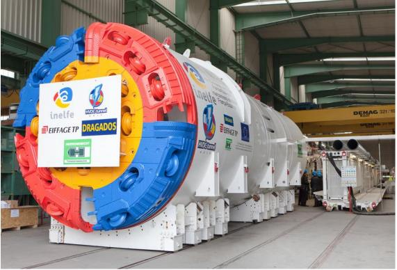
»Canigou« (M-1619M) - eine der beiden Herrenknecht-Doppelschild-TBM (Ø 4.256 mm) für den Vortrieb des INELFE-Tunnel-Projekts.
