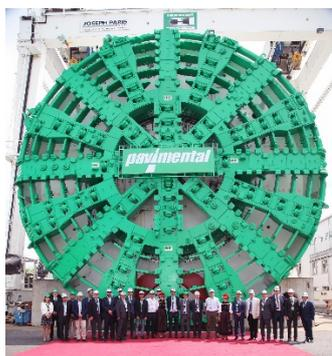
Imposante 15,87 Meter misst der Durchmesser der Tunnelbohrmaschine für den Santa Lucia Tunnel. Damit ist die TBM nicht nur die größte die bisher auf dem Herrenknecht Werksgelände in Schwanau montiert wurde. Auch in ganz Europa kam bisher keine durchmesserstärkere Maschine zum Einsatz. Vorheriger Rekordhalter war das Herrenknecht Erddruckschild für die Galleria Sparvo mit einem Durchmesser von 15,62 Meter.
