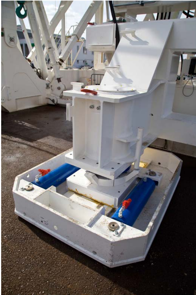
Image 1: Durch das neuentwickelte „X-Y-Stepping“-System mit hydraulischen Zylinderfüßen kann die Tiefbohranlage angehoben und um mehrere Meter versetzt werden. Dadurch lassen sich mehrere Bohrungen in sogenannten „Multi-Bohrplätzen“ bündeln und Zeit einsparen.
