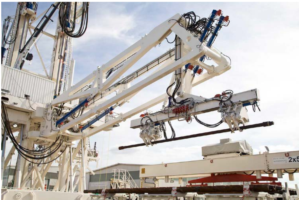
Image 2: Mit dem hydraulischen Pipe Handler werden Bohrgestänge und Casing-Rohre aus der Horizontalen in die vertikale Bohrachse gehoben. Hands-Off-Technologien sorgen für eine hohe Sicherheit im Arbeitsprozess.
