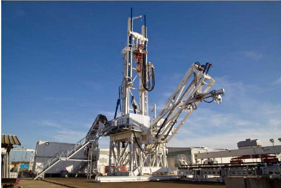
Image 3: Alle Kernkomponenten für das Pipe Handling wie Catwalk, Pipe Handler und Hebewerk sind bei der Anlage vom Typ Terra Invader 350 hoch automatisiert und arbeiten auf Basis des hydraulischen Antriebskonzeptes sehr sicher und präzise.
