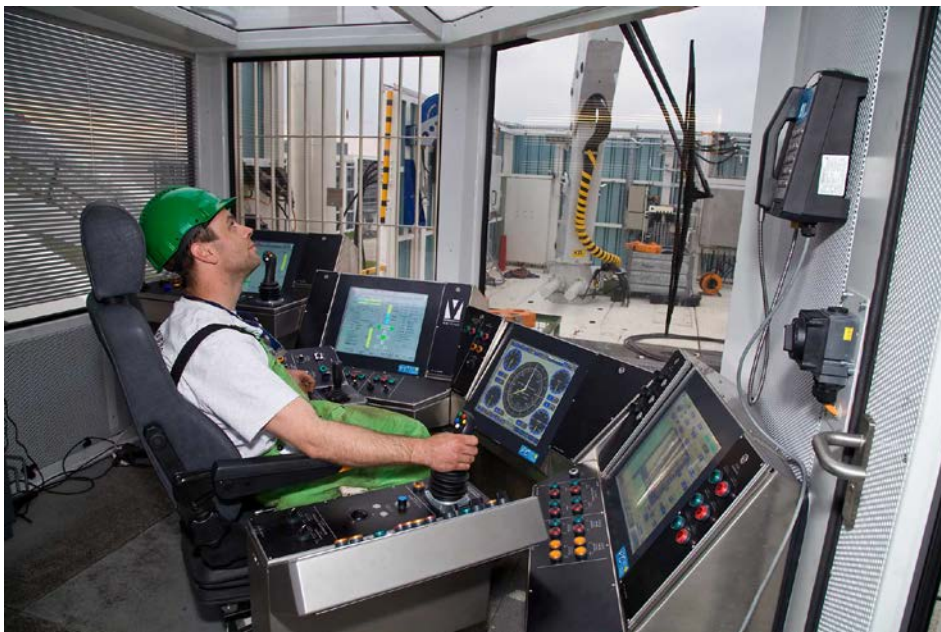
Image 4: Zum Betrieb der gesamten Tiefbohranlage sind pro Arbeitsschicht sind in der Regel nur vier Personen erforderlich. Alle wichtigen Funktionen werden vom Steuerstand aus fernbedient.
