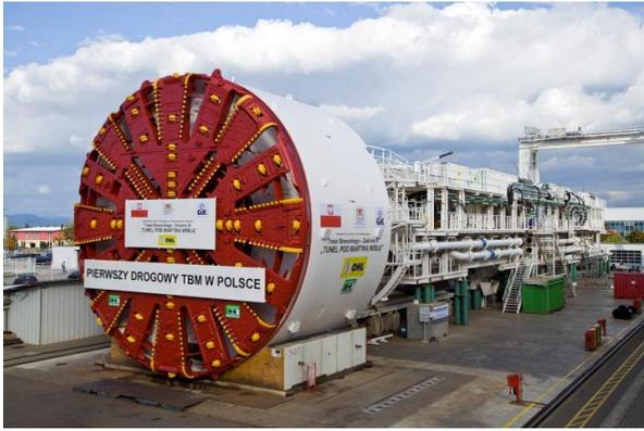
Bild3: Für das Projekt Slowacki-Tunnel designt und lieferte Herrenknecht ein 90 Meter langes Mixschild mit einem Schilddurchmesser von 12,56 Metern.
