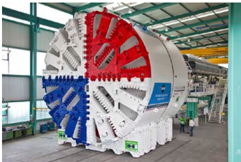
Der Herrenknecht-EPB-Schild S-680 (Ø 9.730 mm) für die U-Bahn-Linie 1 in Panama-Stadt anlässlich der Kundenabnahme im Werk in Schwanau im August 2011.
