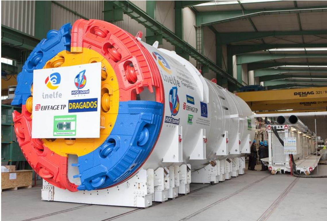
»Canigou« (M-1619M) - eine der beiden Herrenknecht-Doppelschild-TBM ( $\varnothing$  4.256 mm) für den Vortrieb des INELFE-Tunnel-Projekts.
