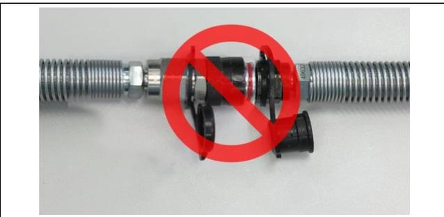
h) Veiller à ce que le connecteur haut pression et le mamelon haut pression soient correctement connectés (photo de gauche). Si la bague rouge est visible le connecteur et le mamelon ne sont pas correctement connectés les uns aux autres (photo de droite).
